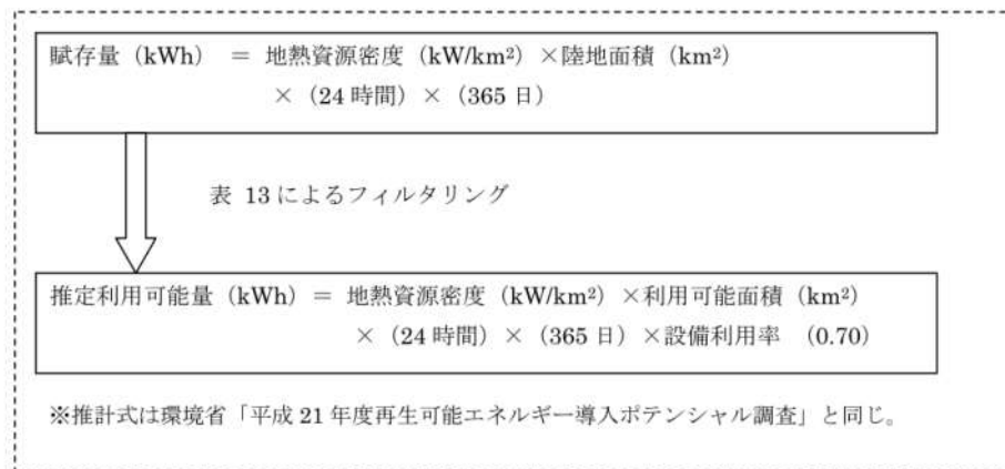
図 15 地熱発電の賦存量・推定利用可能量の推計式
