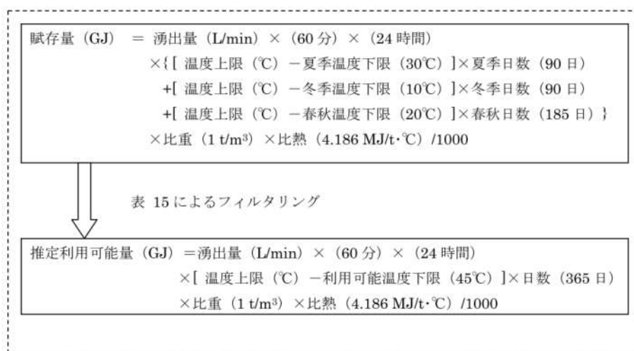
図 17 温泉熱利用の賦存量・推定利用可能量の推計式
