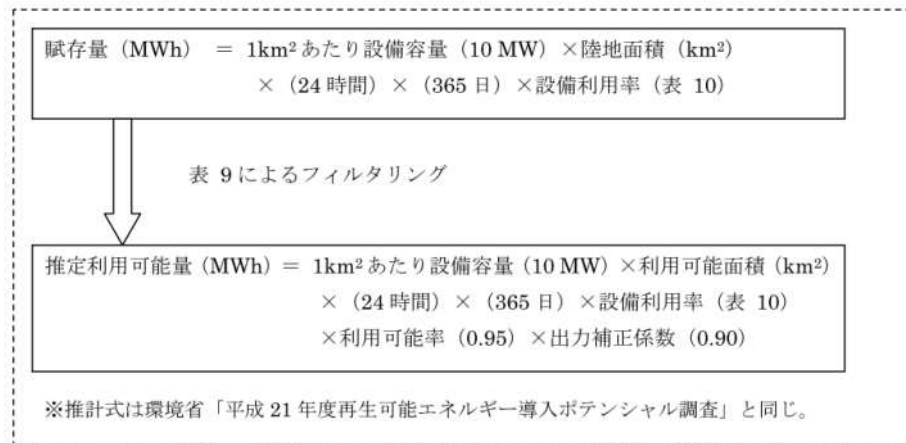
図 8 風力発電の賦存量・推定利用可能量の推計式
