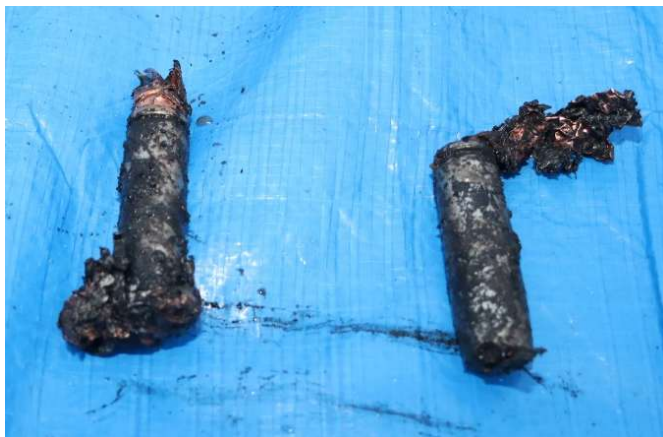
内部の電極が噴出したリチウムイオン電池
