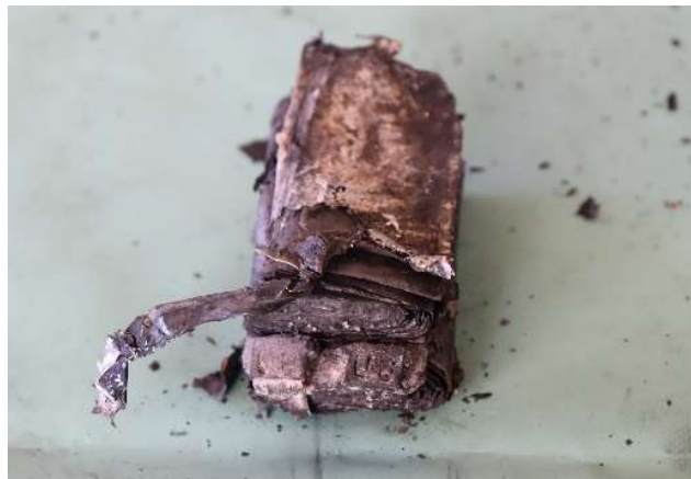
ごみ収集中に火災したモバイルバッテリー
