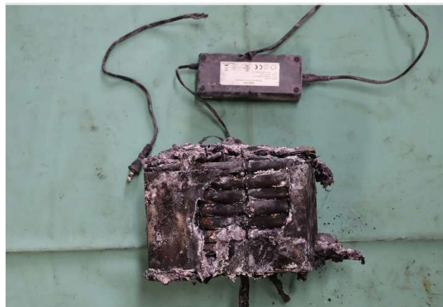
充電中に火災したポータブルバッテリー
