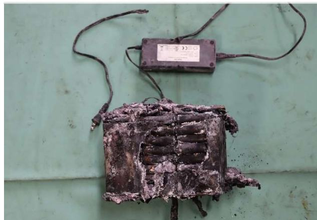
充電中に出火したポータブル電源
