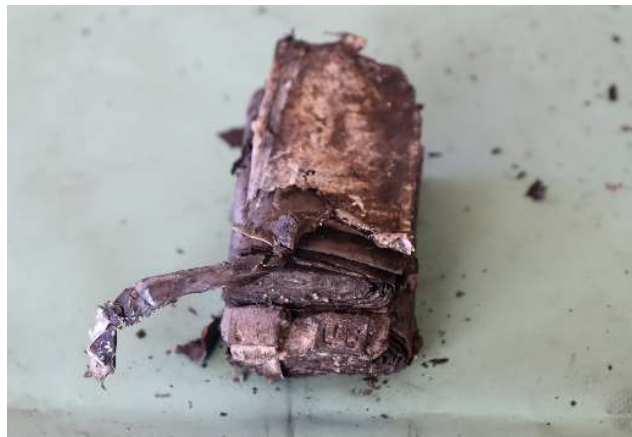
ごみ収集中に出火したモバイルバッテリー
