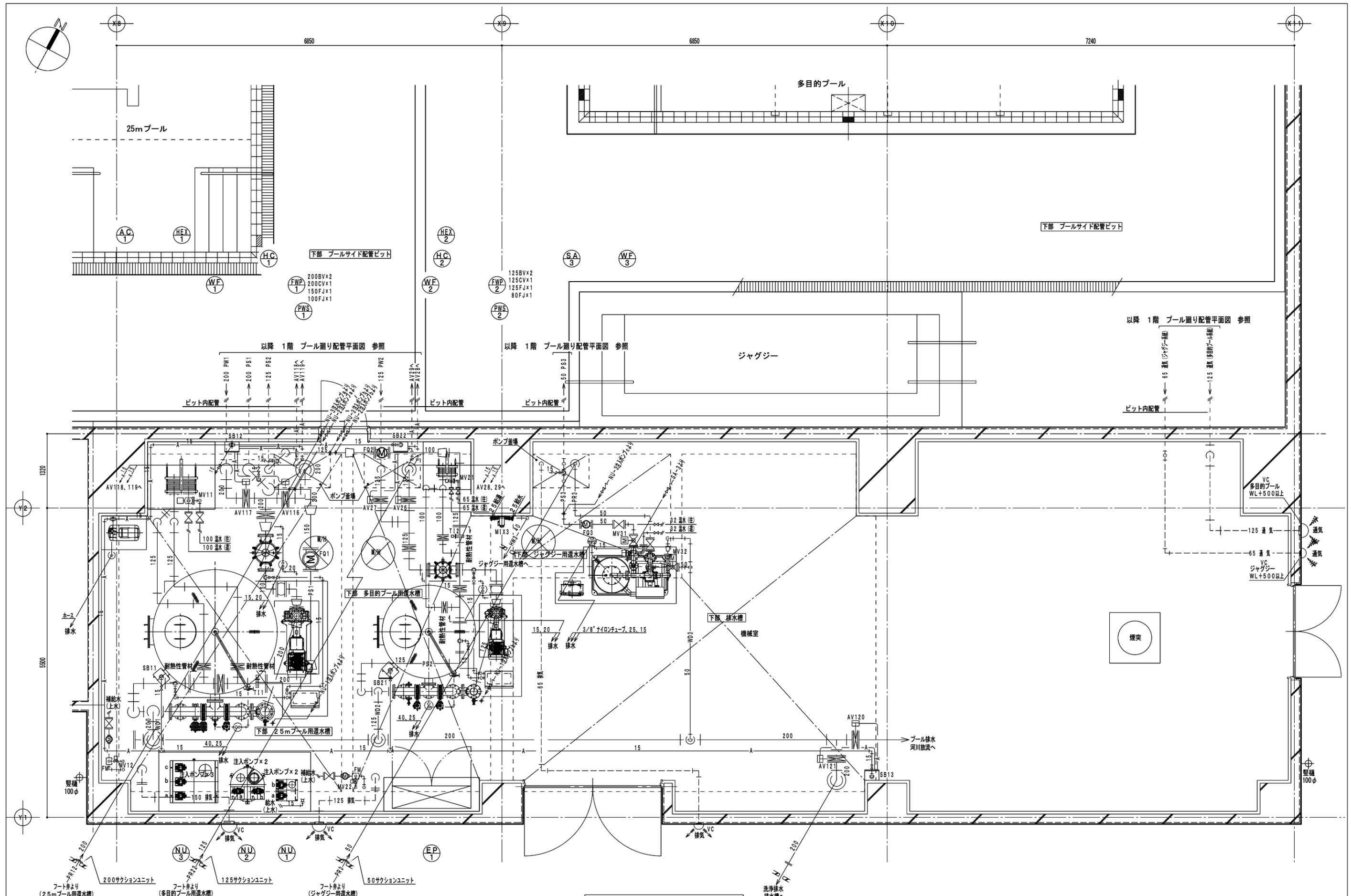
1階 機械室配管平面図 S=1/30
