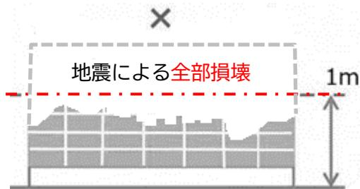
全部損壊により、倒壊の危険がないブロックは1 m以下として「対象外」
