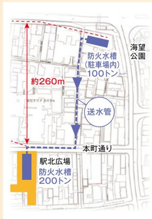
海望公園駐車場と駅北広場に設置した防火水槽2基をつなぐ地下送水管の整備が完了しました。その距離は約260m。駅北広場周辺に残る木造建物密集地域で大規模な火災が発生し、消火用の水が不足した場合は、海望公園にあるバルブを開け、消雪井戸水などを送水することで水量を確保します。
