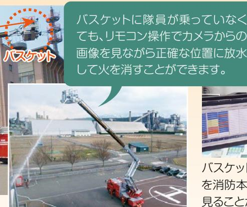
バスケットに隊員が乗っていても、リモコン操作でカメラからの画像を見ながら正確な位置に放水して火を消すことができます。
