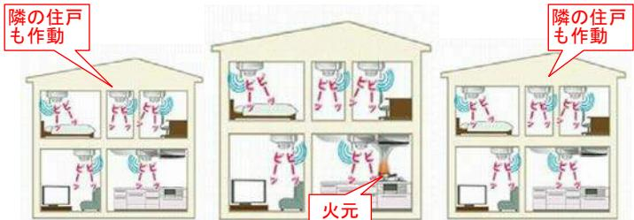
隣接する住戸間で警報器を共同設置。火元以外の住戸も連動して作動
