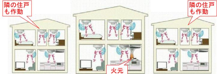
隣接する住戸間で警報器を共同設置。火元以外の住戸も連動して作動
