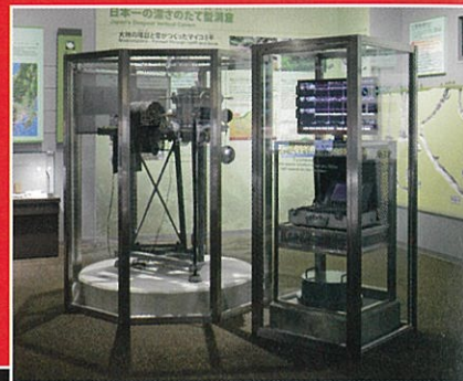
■ウィーヘルト型地震計 約70年前に製造された日本で2台しかない地震計です。
